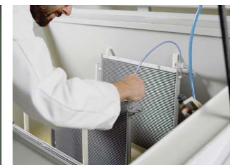
ZAAWANSOWANA PRÓBA ODPORNOŚCI NA KOROZJĘ W KOMORZE SOLNEJ SPRAWDZA ODPORNOŚĆ SKRAPLACZA NA KOROZJĘ
