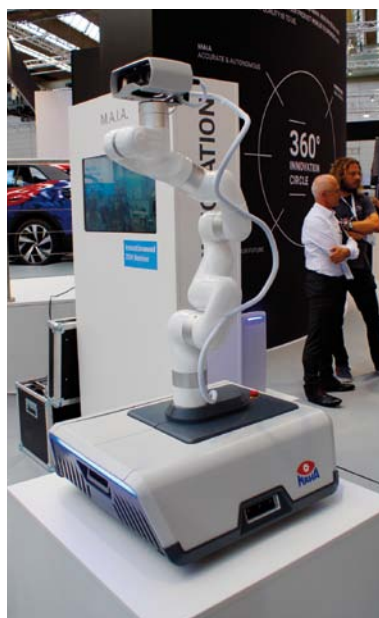
Z LEWEJ: NA STOISKU FIRMY MIRKA ZAPREZENTO- WANO ROBO- TA PRZEMY- ŚŁOWEGO SZLIFUJĄCEGO POWIERZCH- NIE LAKIER- NICZE
