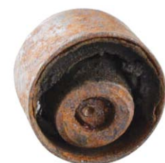
USZKODZONA TULEJA ZAWIESZENIA
