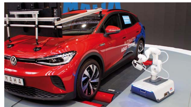
CAŁKOWICIE ZAUTOMATYZOWANY TEST SYSTEMU ADAS DZIĘKI ROBOTOWI INSPEKCYJNEMU M.A.I.A. FIRMY MAHA
