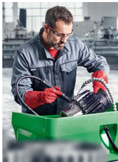
MYJKA Z PĘDZLEM CZYSZCZĄCYM MEWA ECO-CLEAN DOSTĘPNA JEST W WERSJI MINI (POW. ROBOCZA: 70 X 48 CM. NOŚNOŚĆ: 100 KG) ORAZ W WERSJI MAXI (POW. ROBOCZA: 81 X 52 CM. NOŚNOŚĆ: 250 KG)
