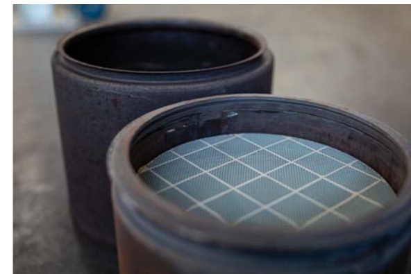
FILTR CZĄSTEK STAŁYCH DO POJAZDÓW CIĘŻAROWYCH PRZED I PO REGENERACJI
