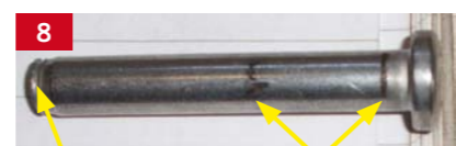
zerwany trzpień śruby ślady styku z napinaczem
