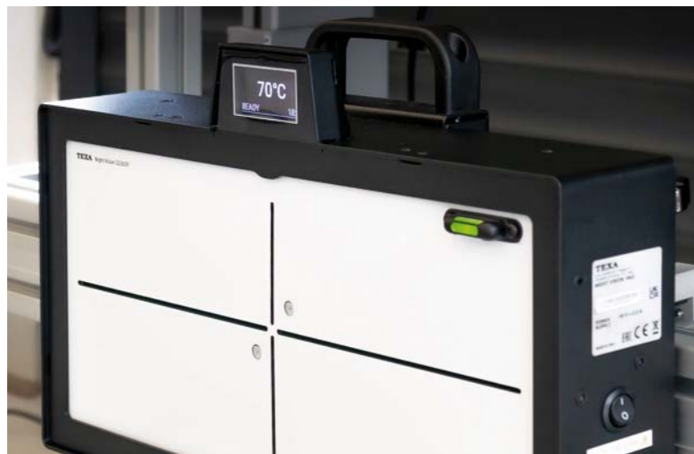
RYS. 7. ABY KALIBRACJA PRZEBIEGŁA PRAWIDŁOWO, URZĄDZENIE TEXA NIGHT VISION MUSI UZYSKAĆ ODPOWIEDNIĄ TEMPERATURĘ
