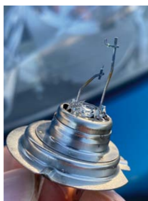
GDY TANIA ŻARÓWKA EKSPLODUJE EFEKTEM SĄ DROBINY SZKŁA I KONIECZNOŚĆ JEJ WYMIANY NA NOWĄ
