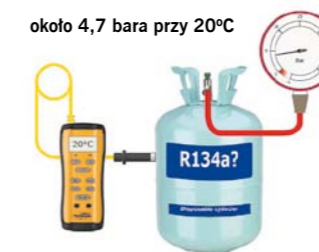
SPRAWDZANIE PRZEZ POMIAR CIŚNIENIA W BUTLI
