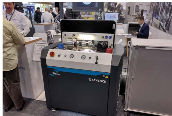
SCHENCK – WYSKOOBROTOWA WYWAŻARKA DO RDZENI TURBOSPRĘŻAREK
