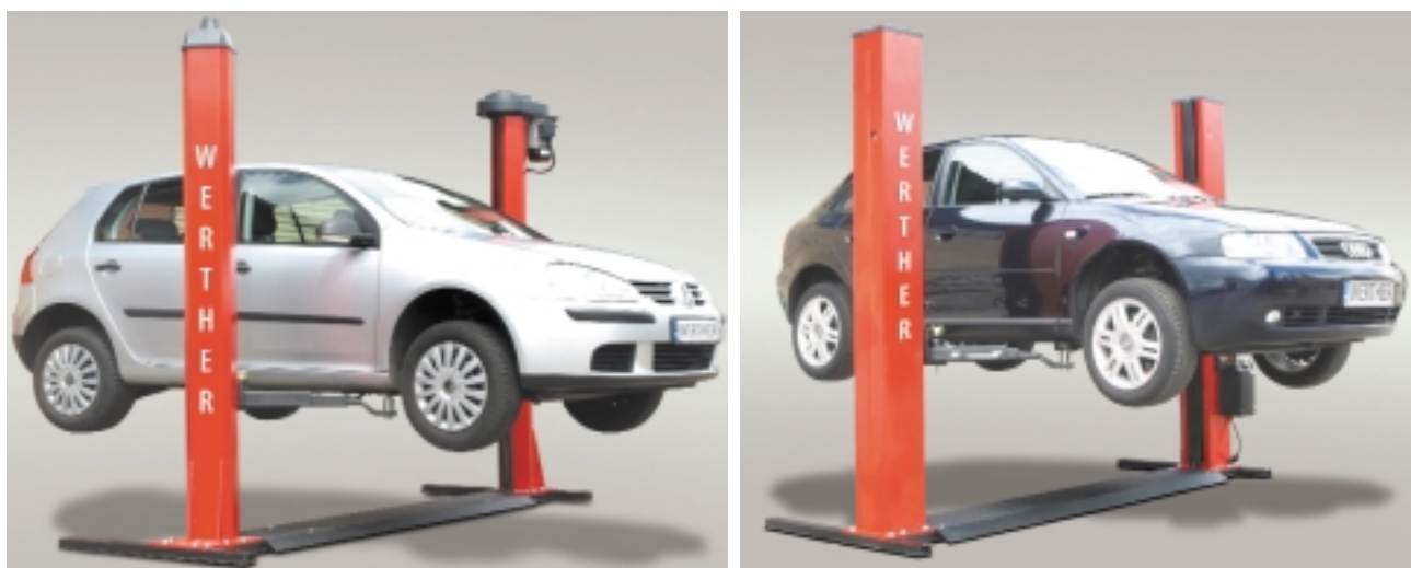
Uniwersalne, dwukolumnowe podnośniki serwisowe. Z lewej: elektrohydrauliczny, z prawej: elektromechaniczny
