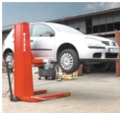
Podnośniki mobilne pozwalają tworzyć pomocnicze stanowiska robocze nawet na zewnątrz budynków
