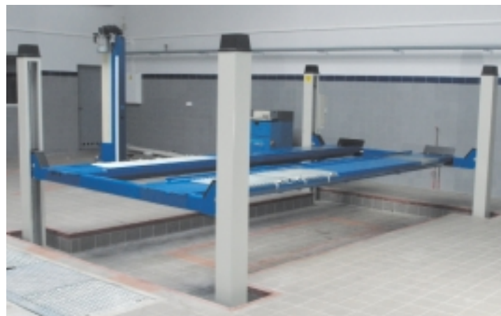
Konstrukcja czterokolumnowa łączy wszystkie zalety stanowisk podnośnikowych i kanałowych
