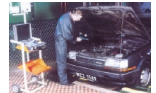
Stanowisko rolkowe do szybkiej, kompleksowej kontroli stanu zespołów napędowych
