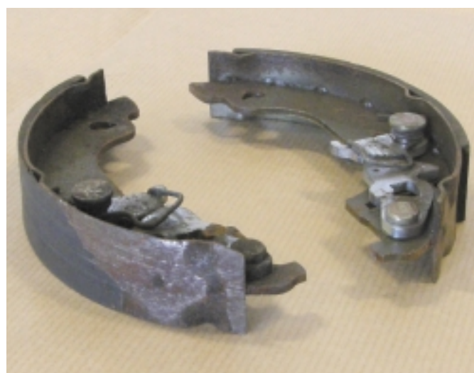
Nierównomierne zużycie okładzin na skutek wadliwej pracy rozpieracza hydraulicznego
