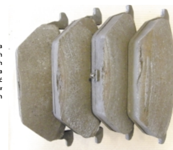
Nowe klocki założone do zużytej tarczy współpracują z nią na niedostatecznej powierzchni. Szybko też ulegają zniszczeniu
