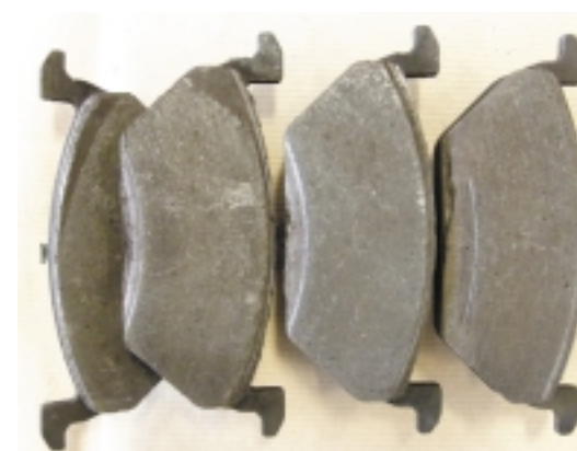
Nowe klocki założone do zużytej tarczy współpracują z nią na niedostatecznej powierzchni. Szybko też ulegają zniszczeniu
