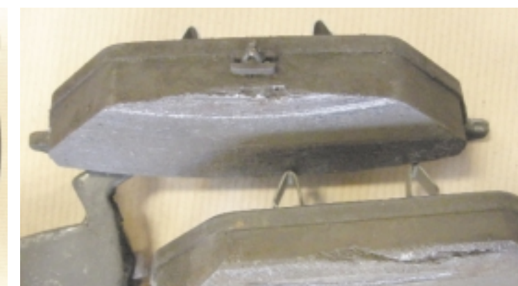
Nowe klocki założone do zużytej tarczy współpracują z nią na niedostatecznej powierzchni. Szybko też ulegają zniszczeniu
