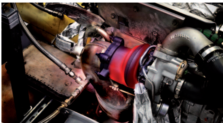
Standardowy olej nie odprowadza nadmiaru ciepła z turbosprężarki
