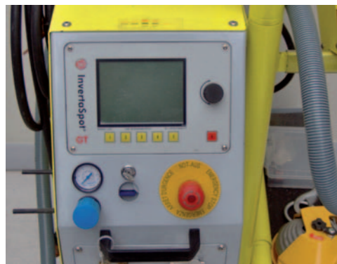
Panel sterowania automatycznej zgrzewarki inwertorowej najnowszej generacji
