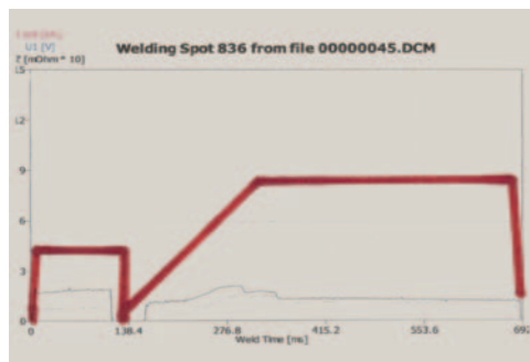
Charakterystyka natężenia prądu przy wykonywaniu zgrzeiny za pomocą dwóch kolejnych impulsów elektrycznych
