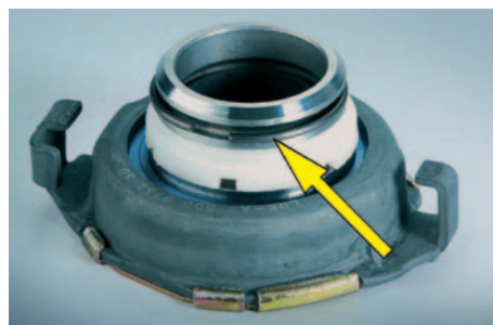
Zasada automatycznego zatraskiwania się sprężystego pierścienia blokującego w mechanizmie wysprzęglającym sprzęgła ciągniętego
