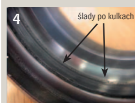
4 ślady po kulkach Nieprawidłowa współpraca kulek z bieżnią z powodu wadliwej pozycji łożyska lub niewłaściwego momentu dokręcenia śruby
