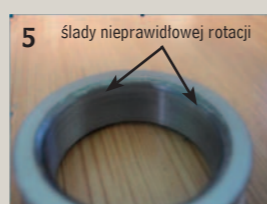
5 ślady nieprawidłowej rotacji Inny skutek niewłaściwego momentu dokręcenia śruby
