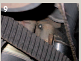
9 Pozostałości uszkodzonych elementów, które należy bezwzględnie usunąć z komory napędu rozrządu
