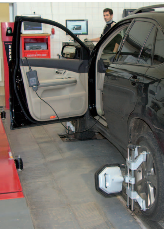
Moduł CodeLink™ podłącza się do gniazda diagnostycznego samochodu na stanowisku do kontroli geometrii podwozia
