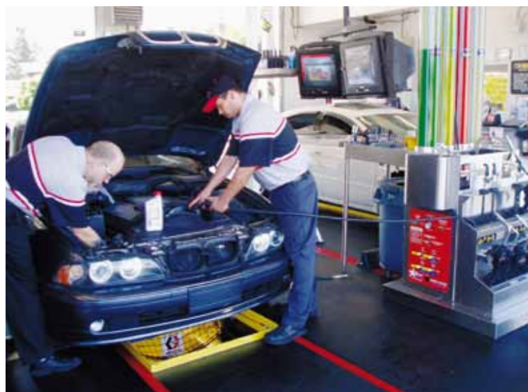
STANOWISKO DO NAPEŁNIANIA UKŁADÓW ŚWIEŻYM OLEJEM
