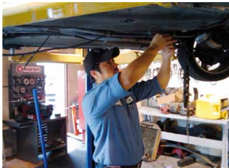
DO WYGODNEJ OBŚLUGI KORKA SPUSTOWEGO I FILTRU KO- NIECZNY JEST PODNOŚNIK
