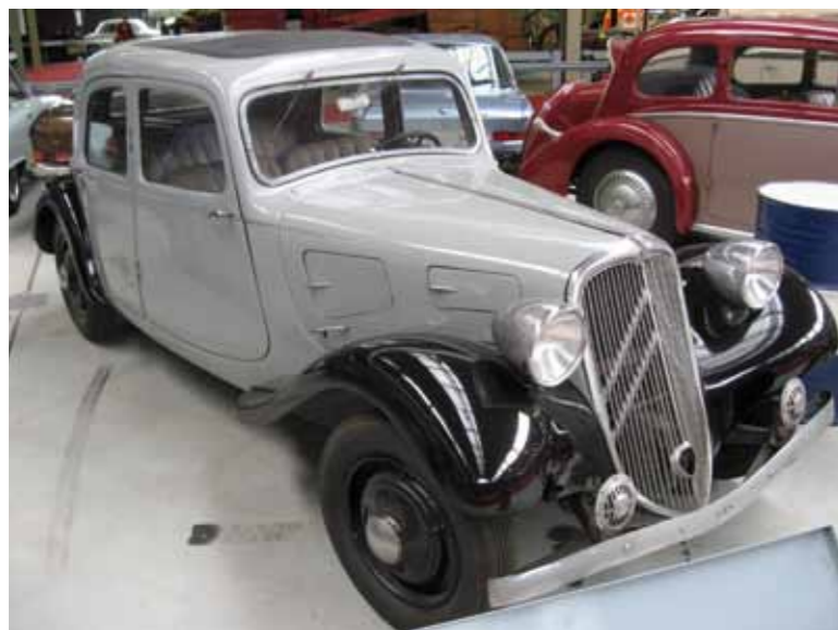
ZA PRAWDZIWIY JEDNAK POCZĄTEK EPOKI NADWOZI CAŁKOWICIE SAMONOŚNYCH UZNAJE SIĘ TEN PRZEDWOJENNY MODEL CITROËNA. POZBAWIONY JAKIEJKOLWIEK RAMY
