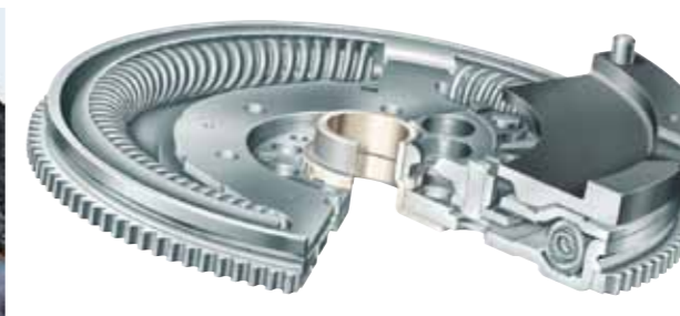
DŁUŻSZE SPRĘŻYNY OBWODOWE ŁĄCZĄCE DWIE MASY DKZ ZAPEWNIĄJĄ SKUTECZNIEJSZE TŁUMIENIE DRGAŃ
