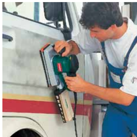
PRZYGOTOWANIE PODŁOŻA DO NAPRAWY CZĘŚCIOWEJ OBEJMUJE RÓŻNE RODZAJE OBRÓBK SZLIFIERSKIEJ
