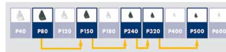
KLASYFIKACJA MATERIAŁÓW ŚCIERNYCH WEDŁUG WIELKOŚCI I ROZMIESZCZENIA ZIAREN ŚCIERNIWA
