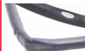
Ostre załamanie przewodu może spowodować uszkodzenie rdzenia
