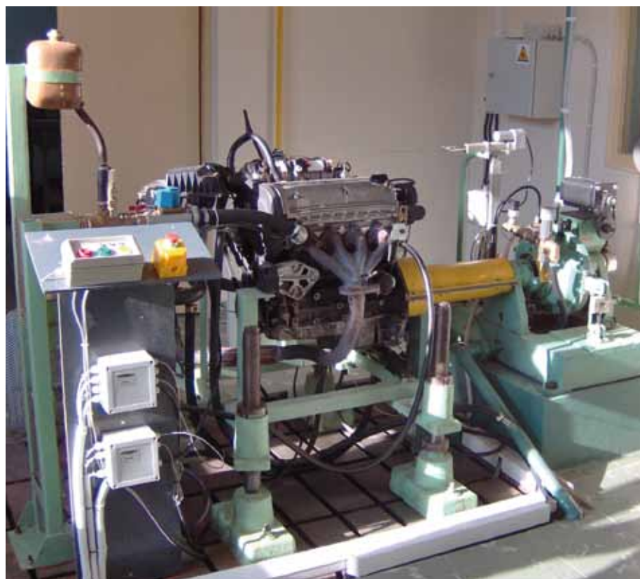
LABORATORIUM ISKRY: STANOWISKO DO BADAŃ ZAPŁONU W SERYJNYM SILNIKU SAMOCHODOWYM PRZY ZASILANIU BENZYNĄ I GAZEM CNG
