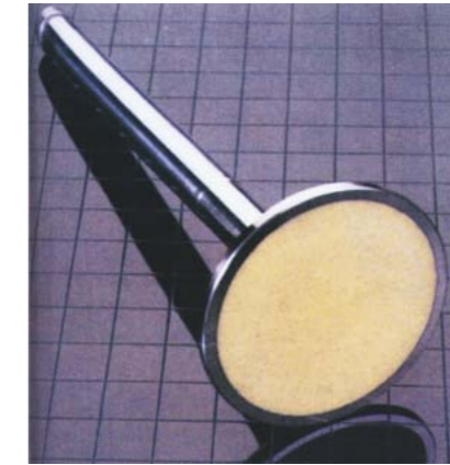
CZOŁO GRZYBKAWO ZAWORU POKRYTE WARSZTĄ CERAMICZNĄ
