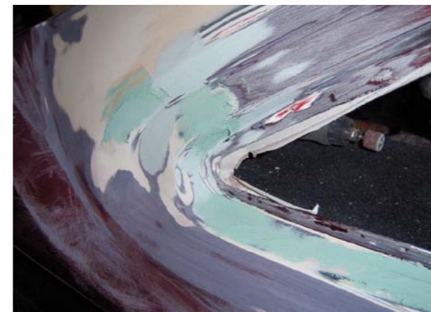
PRZY STOSUNKOWO GŁĘBOKICH NIERÓWNOŚCIACH PODŁOŻA KIT SZPACHLOWY NAKŁADA SIĘ KILKOMI WARSTWAMI (Z LEWEJ), A PRZY WKŁĘŚŁOŚCIACH ROZLEGŁYCH, LECZ PŁYTKICH (Z PRAWYJ) CELOWE STAJE SIĘ UŻYCIĘ SZPACHLÓWKI NATRYSKOWEJ
