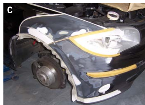
PO OSZLIFOWANIU USZKODZONEJ STREFY USTALA SIĘ METODY WYRÓWNIANIA POWIERZCHNI (A). GŁĘBSZE WKŁĘŚŁOŚCI RÓWNA SIĘ Z SĄSIEDNIĄ POWIERZCHNIĄ LAKIERU KITEM, A POTEM SZLIFUJE I LAKIERUJE CAŁĄ STREFĘ (B). PODOBNIJE POSTĘPUJE SIĘ W PRZYPADKU LICZNYCH NIERÓWNOŚCI PODŁOŻA (C). UBYTKI WYSTĘPUJĄCE TYLKO W POWŁOCE MOŻNA WYRÓWNAĆ SAMYM WYPEŁNIACZEM (D)
