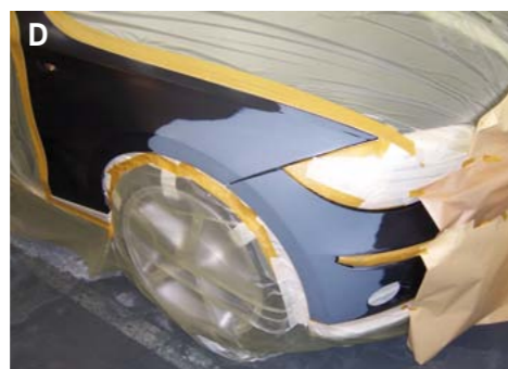
PO OSZLIFOWANIU USZKODZONEJ STREFY USTALA SIĘ METODY WYRÓWNIANIA POWIERZCHNI (A). GŁĘBSZE WKŁĘŚŁOŚCI RÓWNA SIĘ Z SĄSIEDNIĄ POWIERZCHNIĄ LAKIERU KITEM, A POTEM SZLIFUJE I LAKIERUJE CAŁĄ STREFĘ (B). PODOBNIJE POSTĘPUJE SIĘ W PRZYPADKU LICZNYCH NIERÓWNOŚCI PODŁOŻA (C). UBYTKI WYSTĘPUJĄCE TYLKO W POWŁOCE MOŻNA WYRÓWNAĆ SAMYM WYPEŁNIACZEM (D)
