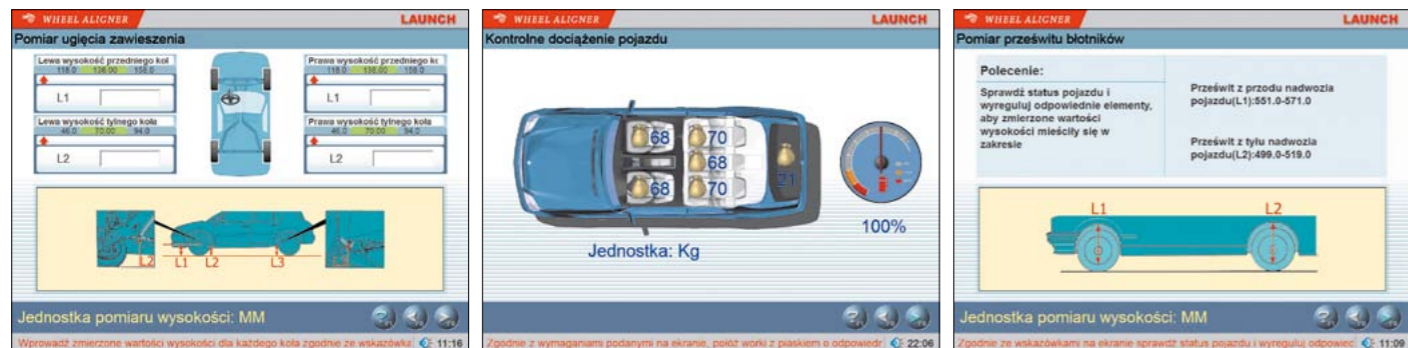
PRZYGOTOWANIE POJAZDU DO BADAŃ WEDŁUG INSTRUKCJI ZAWARTEJ W OPROGRAMOWANIU URZĄDZENIA POMIAROWEGO; OD LEWEJ: KONTROLA UGIĘCIA ZAWIESZENIA, SPOSÓB DOCIĄŻENIA WORKAMI Z PIASKIEM I PALIWEM W ZBIORNIKU, POMIAR USYTUOWANIA KÓŁ WE WNEKACH BŁOTNIKÓW
