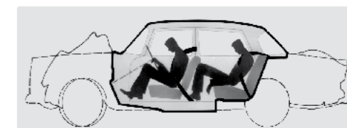
STWORZONA PRZEZ KONSTRUKTORÓW MERCEDESA W POŁOWIE UBIEGŁEGO WIEKU I OBOWIĄZUJĄCA DO DZISIAJ KONCEPCJA PODZIAŁU NADWOZIA NA STREFY PODATNE I SZTYWNE
