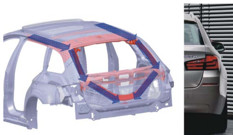
ZMIANA KONSTRUKCJI I FUNKCJI TYLNYCH DRZWI NADWOZIA W CELU ZWIĘKSZENIA ICH UDZIAŁU W PRZENOSZENIU SIŁ PODCZAS KOLIZJI DROGOWEJ
