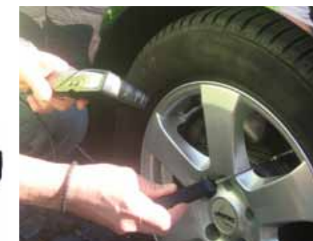
POMIAR TEMPERATURY HAMULCÓW PODCZAS PRÓB TERENOWYCH NA TORZE FIRMY CONTINENTAL
