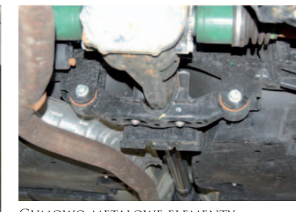
GUMOWO-METALOWE ELEMENTY ZAWIESZENIA UKŁADU NAPĘDOWEGO, BĘDĄCE POTENCJALNYM ŹRÓDŁEM WIBRACJI (SUBARU OUTBACK)
