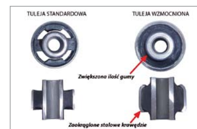
SPOSÓB WZMACNIANIA TULEI METALOWO-GUMOWEJ
