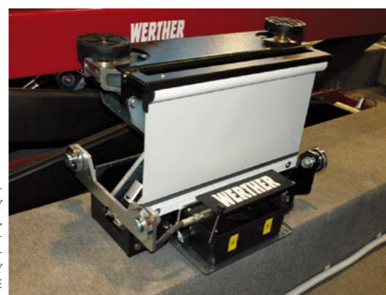
NOŻYCO- WY PODNOŚNIK POMOCNICZY Z ŻALUŻĄ OCHRONNĄ. ZAPOBIEGAJĄCĄ PRZY- CIĘCIU RĄK OPERATO- RA PRZEZ ELEMENTY PODPOROWE
