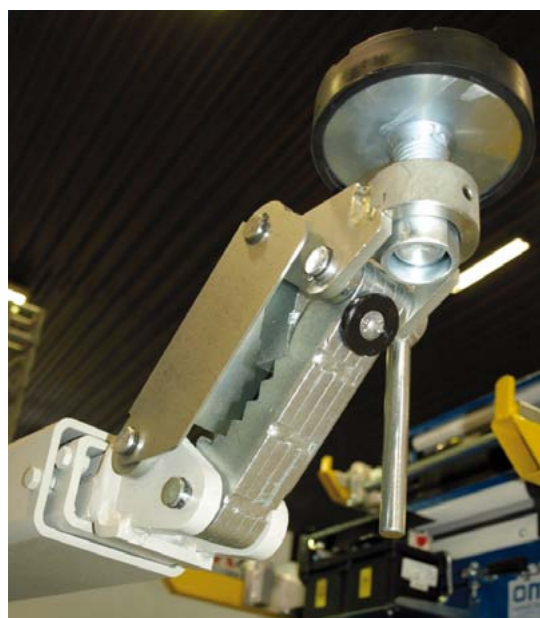
MECHANIZM ZAPADKOWY PODNOŚNIKA CZTERO-KOLUMNOWEGO. LISTWA Z NACIĘCIAMI SŁUŻY RÓWNIŻ DO SAMOPOZIOMOWANIA PLATFORMY
