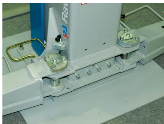
ELEMENTY AUTOMATYCZNEGO MECHANIZMU BLOKUJĄCEGO OBRÓT RAMION PODPOROWYCH
