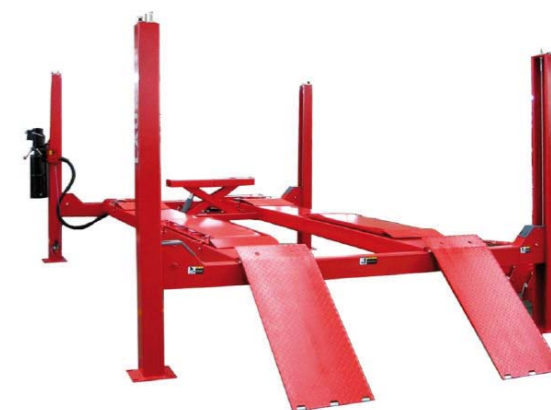
DŹWIGNIK DIAGNOSTYCZNY, CZTEROKOLUMNOWY Z POMOCNICZYM PODNOŚNIKIEM OSI
