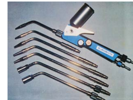
PALNIK DO NAPAWANIA PROSZKAMI Z KOMPLETEM KOŃCÓWEK
