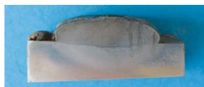
PRZEKRÓJ PRÓBKI Z POJEDYNCZĄ NAPIOINĄ (STAL NA STALI)
