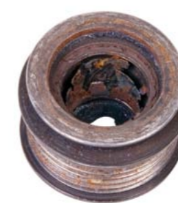
Z LEWEJ: PĘKNIĘCIE RAMIENIA NAPINAJĄCEGO Z POWODU NADMIERNYCH JEGO PRZEMIESZCZEŃ; Z PRAWYJ: USZKODZENIE JEDNOKIERUNKOWEGO MECHANIZMU BLOKUJĄCEGO (ALTERNATOR PRZESTAJE DZIAŁAĆ)
