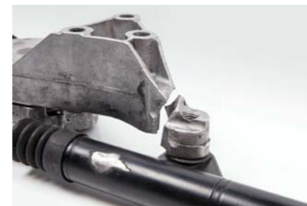
Z LEWEJ: PĘKNIĘCIE RAMIENIA NAPINAJĄCEGO Z POWODU NADMIERNYCH JEGO PRZEMIESZCZEŃ; Z PRAWYJ: USZKODZENIE JEDNOKIERUNKOWEGO MECHANIZMU BLOKUJĄCEGO (ALTERNATOR PRZESTAJE DZIAŁAĆ)
