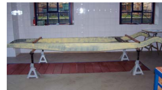
GOTOWA RAMA TO DWIE PODŁUŻNICE POŁĄCZONE PRZYKRĘCONYMI DO NICH POPRZECZKAMI
