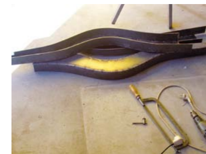
ZESPRAWANE PROFILE ODPOWIADAJĄ WYMIARAMI I KształETEM ORYGINALNYM, KUTYM
