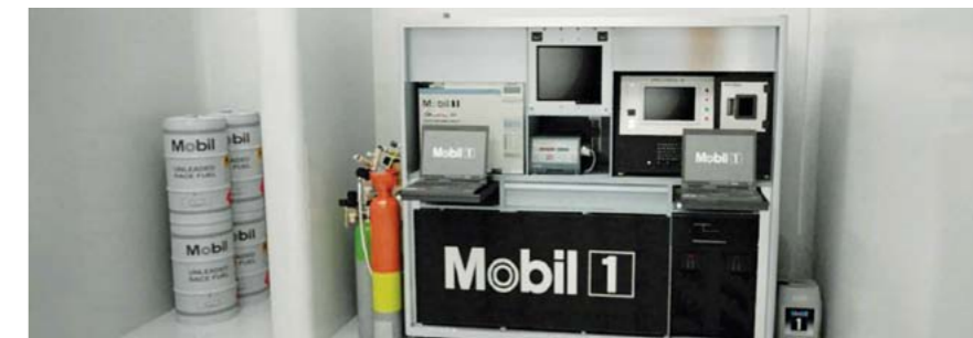
MAC MOBIL 1 ANALYTICAL CENTRE. CZYLI MOBILNE LABORATORIUM ANALITYCZNE UŻYWANE W BOKSACH SERWISOWYCH FORMUŁY 1
