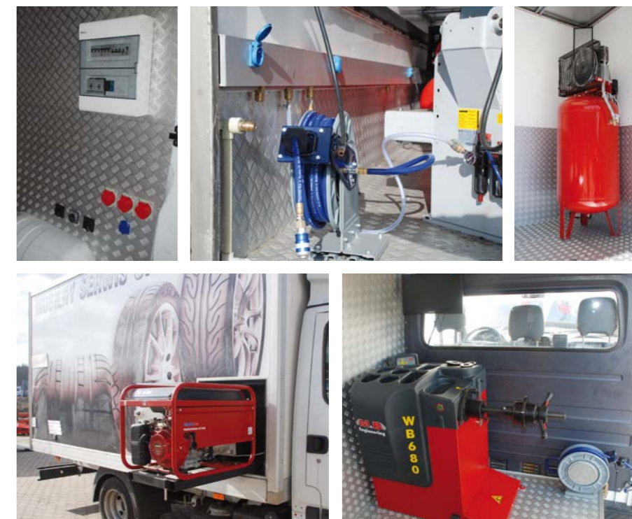
PRZYKŁADOWE ELEMENTY WYPOSAŻENIA – INSTALACJA ELEKTRYCZNA, INSTALACJA PNEUMATYCZNA, KOMPRESOR, AGREGAT PRĄDOTWÓRCZY I WYWAŻARKA
