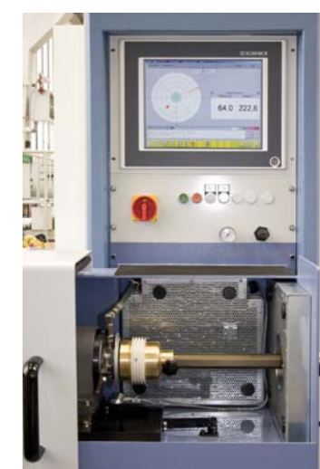
SPRAWDZANIE NIETYWAŻENIA ORAZ PRĘDKOŚCI, PRZYSPIESZENIA I PRZEMIESZCZANIA DRGAŃ
