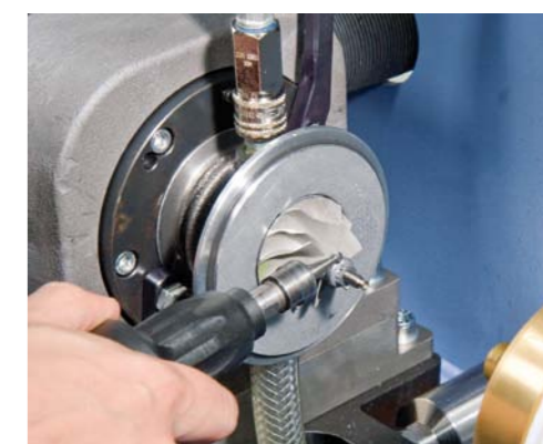
KOREKCA NIETYWAŻENIA BEZPOŚREDNIO NA WYWAŻARCE
