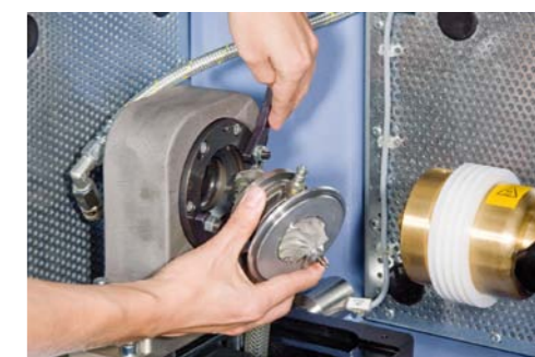
ZMONTOWANY RDZEŃ TURBOSPŔĘŻARKI W WYSOKOOBROTOWEJ WYWAŻARCE SCHENCK 110MBRS
