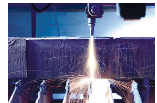
PRZEBIEG CIĘCIA. DOBRZE WIDOCZNE WŻERY NA POWIERZCHNI MATERIAŁU
