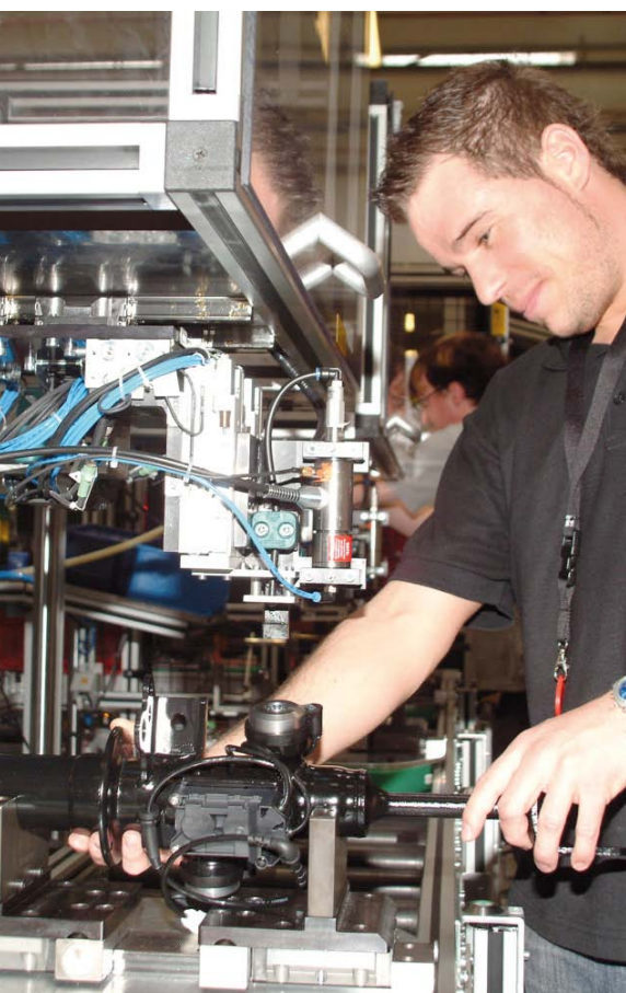
MONTAŻ AMORTYZATORÓW SACHS CDC W FABRYCE ZF W SCHWEINFURCIE
