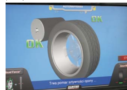
17. Po usunięciu niewyważenia urządzenie bada rolką dociskową jednorodność sztywności opony i sprawdza, czy mieści się ona w dopuszczalnym zakresie
