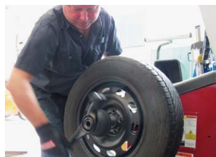
7. Pozostaje już tylko docisnąć felgę nakrętką wrzeczona, wykorzystując jego ruch obrotowy
