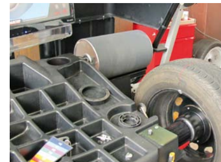
14. Maszyna obraca koło ku górze miejscem nabicia ciężarka i podnosi osłonę, a laser oznacza je, dokładnie wyświetlając linię pokazaną na ekranie
