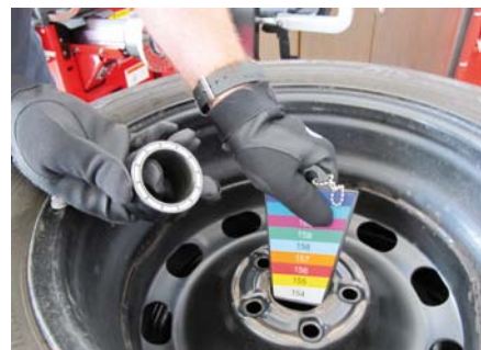
4. Dobór właściwego stożka do otworu felgi ułatwia prosty wzornik
