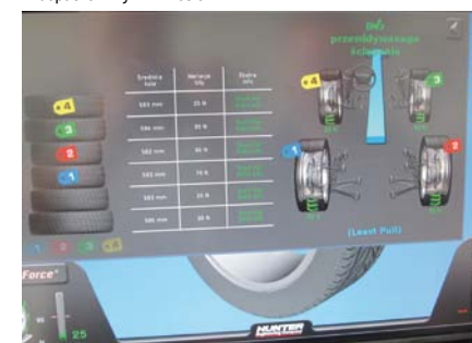
20. Na podstawie danych dla dowolnej liczby (co najmniej czterech) kół program określa ich optymalne pozycje w pojeździe
