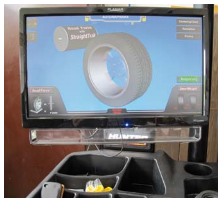
2. Maszyna gotowa jest do pracy natychmiast po włączeniu. Wstępna jej kalibracja przeprowadzana jest samoczynnie przez odpowiedni program
