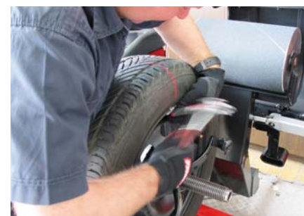
16. Ciężarek po stronie zewnętrznej (gdz jest on potrzebny) mocuje się również według danych z ekranu i laserowej linii na kole
