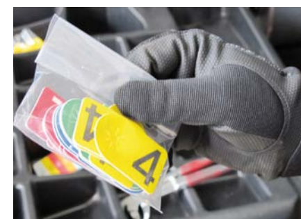
21. Do identyfikacji kół służą kolorowe, numerowane zawieszki, osadzone na zaworach powietrznych
