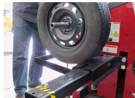
6. Podnośnik nie jest przy tym rozmiarze kół konieczny, lecz pomaga on precyzyjnie naprowadzić otwór felgi na wrzeciono
