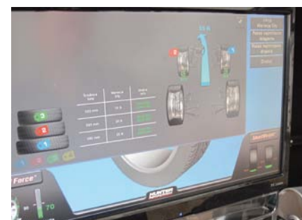
19. Rolka w ramach tzw. testu drogowego mierzy też boczne znoszenie koła i ewentualne drgania poprzeczne
