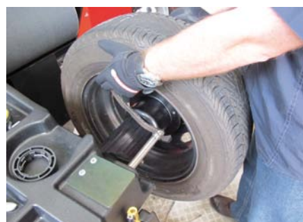
8. Pomiar średnicy, szerokości i bicia obręczy wykonuje się, przytykając do jej obrzeża najpierw wewnętrzne ramię czujnikowe...
