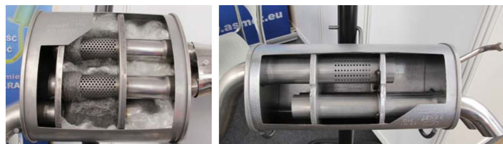
TŁUMIKI ASMET Z KORPUSAMI ZAWIJANYMI. Z LEWEJ: KONSTRUKCJA REFLEKSYJNO-ADSORPCYJNA, Z PRAWYJ: REFLEKSYJNA
