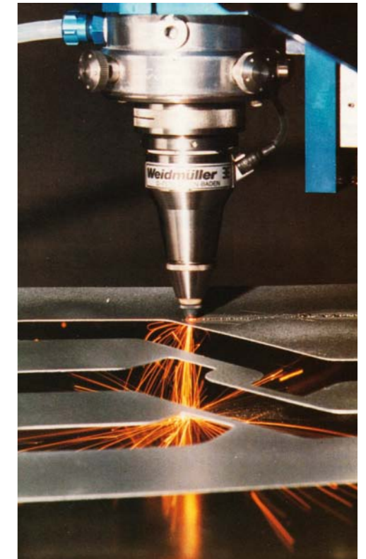
PLAZMOWE CIĘCIE STALI WYSOKOSTOPOWEJ
