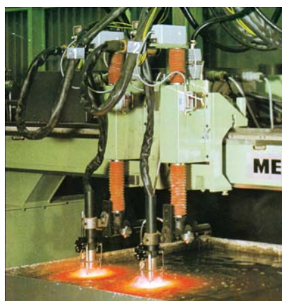
Z LEWEJ: DWUGŁOWICOWE CIĘCIE PLAZMOWE POD LUSTREM WODY. POWYŻEJ: WYSOKOWYDAJNE CIĘCIE PLAZMOWE
