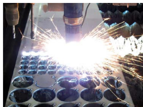
Z LEWEJ: DWUGŁOWICOWE CIĘCIE PLAZMOWE POD LUSTREM WODY. POWYŻEJ: WYSOKOWYDAJNE CIĘCIE PLAZMOWE
