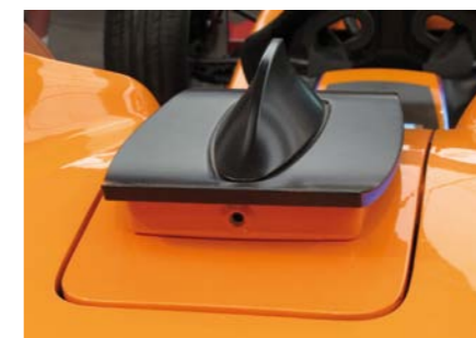
DODATKOWY MODUŁ, ZHARMONIZOWANY Z BRYŁĄ POJAZDU, MIEŚCI W SWYM WNĘTRZU BARDZO CZUŁE ANTENY DO ODBIORU WSZELKICH SYGNAŁÓW WEWNĘTRZNYCH, A TAKŻE KAMERĘ COFANIA ZASTĘPUJĄCĄ RÓWNIEŻ LUSTERKA WSTECZNE
