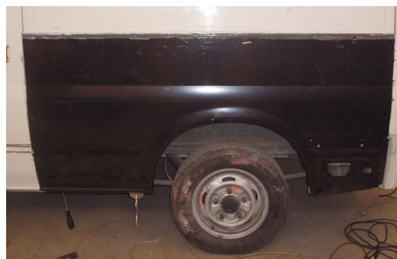
BOCZNY PŁAT ZEWNIĘTRZNEGO POSZYCIA WYMIENIONY METODĄ KLEJENIA
