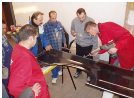
KLEJ NANOSI SIĘ WĄSKIM PASMEM NA ŁĄCZONE BRZEGI NOWEGO ELEMENTU PO JEGO STRONIE WEWNĘTRZNEJ
