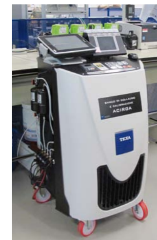
PROTOTYPOWY MODEL URZĄDZENIA DO OBSŁUGI KLIMATYZACJI SAMOCHODOWYCH PODCZAS PRÓB NA STANOWISKU KONTROLNO-TESTOWYM
